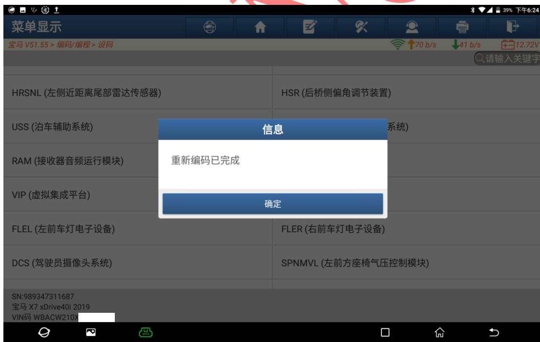
12. 退出设码，重新进入“RAM（接收器音频运行模块）”系统执行一遍清码，然后重读故障码，显示“无故障码”，设码结束（如下图）。
