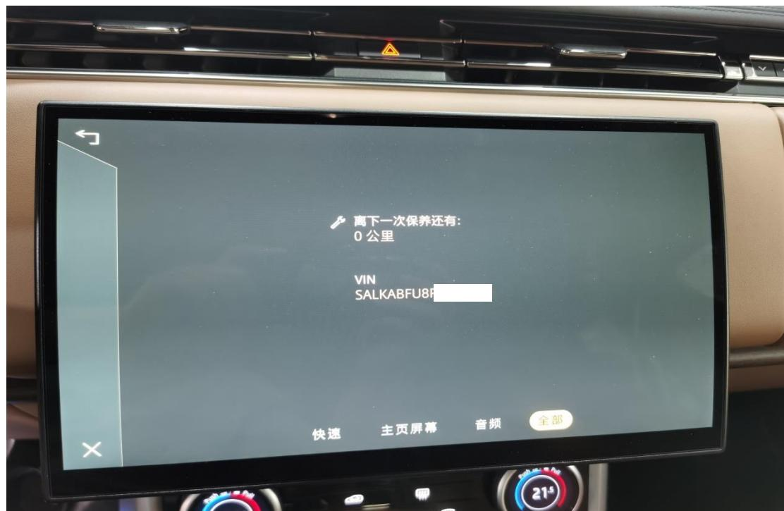
2. 选择【X431-PAD5】设备，选择【智能诊断】识别出车辆信息，确认无误后点【诊断】（如下图）；
