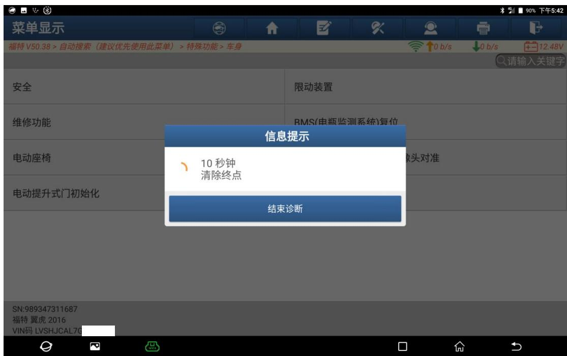
9. 提示“提升式车门打开”，尾门将打开，注意保持安全距离（如下图）：
