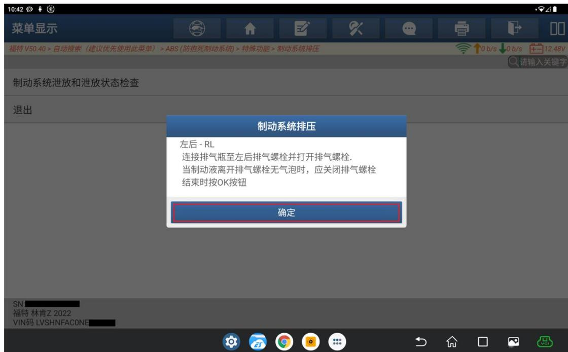
15. 关闭电源放气阀（此步骤指的是关闭通过气压或电动泵向刹车油储液罐加压，以将刹车油路中的空气快速排出的这种设备上的气压阀门或者电源开关）
