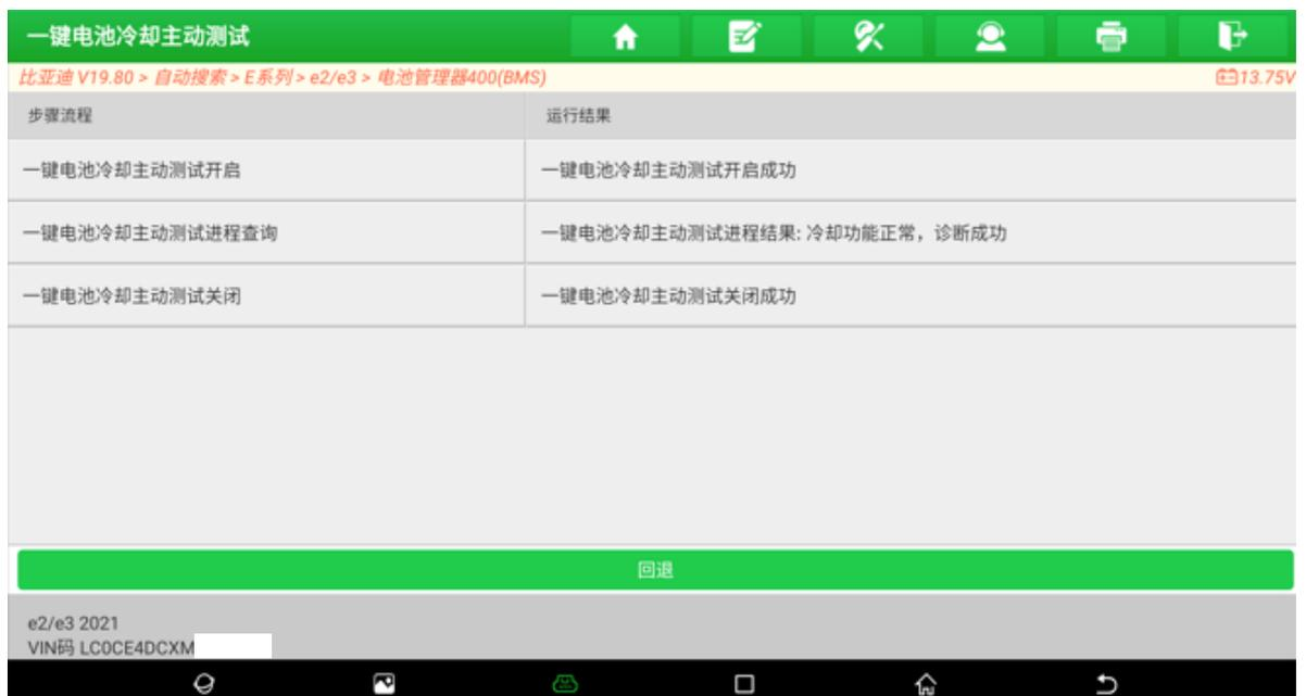
8. 开启成功后可以看到功能进行中、也可以听到水泵工作的响声，并且冷却液会进行排气液位会持续下降。
