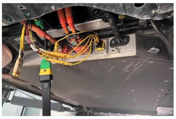
9. 连接好线束后,点击返回退出跳线图界面,点击进入跳线诊断
