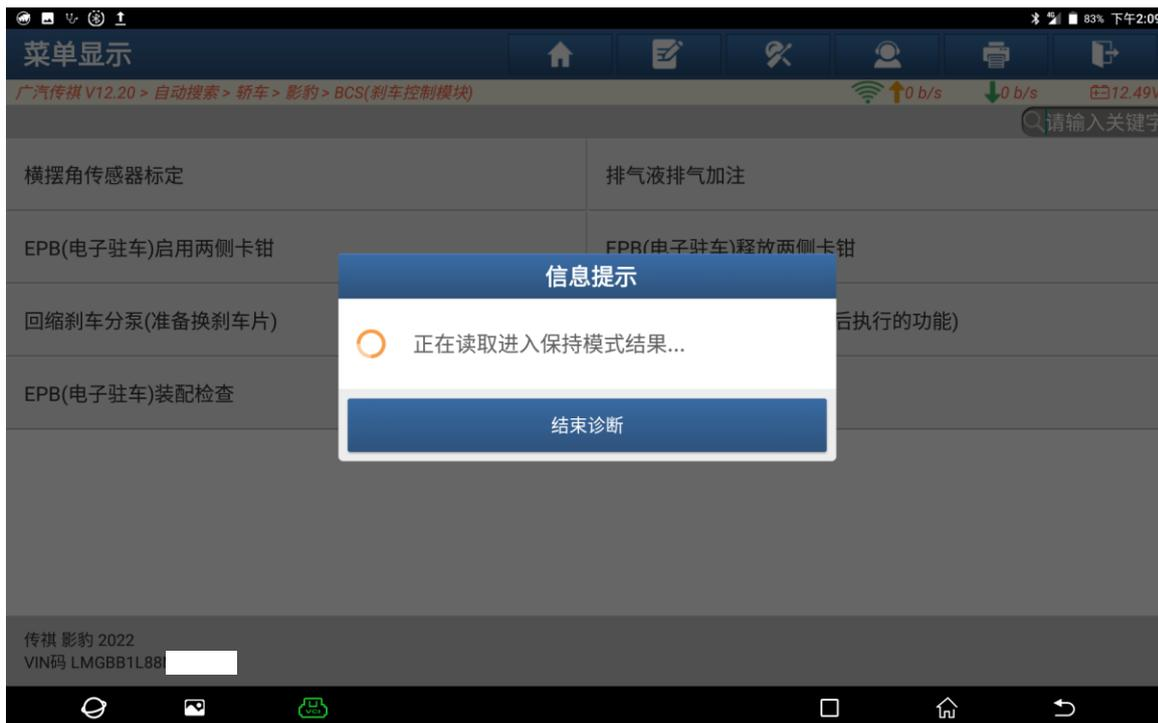
6. 卡钳已释放，下电更换刹车片（如下图）；
