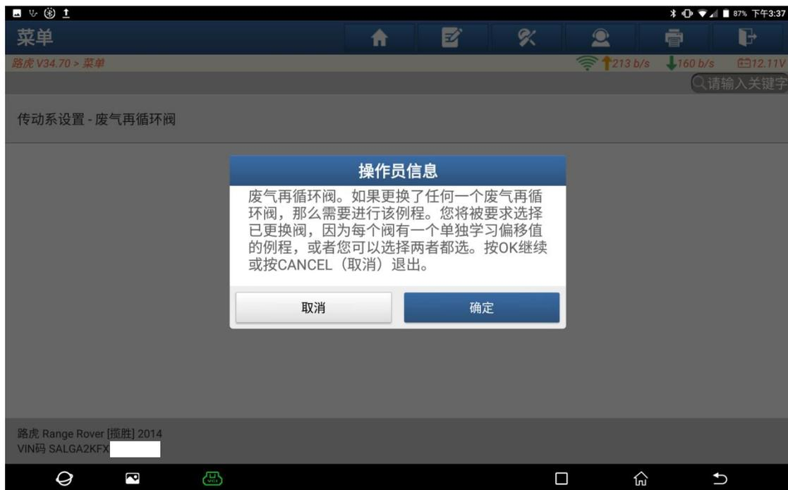
7. 根据更换的废气阀来选择菜单，如更换缸组 1 的废气阀，选择【缸组 1】（如下图）；
