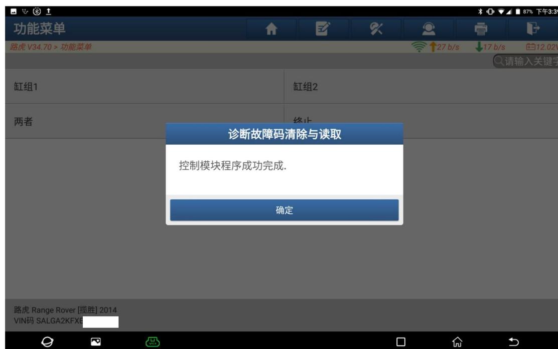
17. 提示“关闭点火开关”，然后，点“确定”，学习完成（如下图）。
