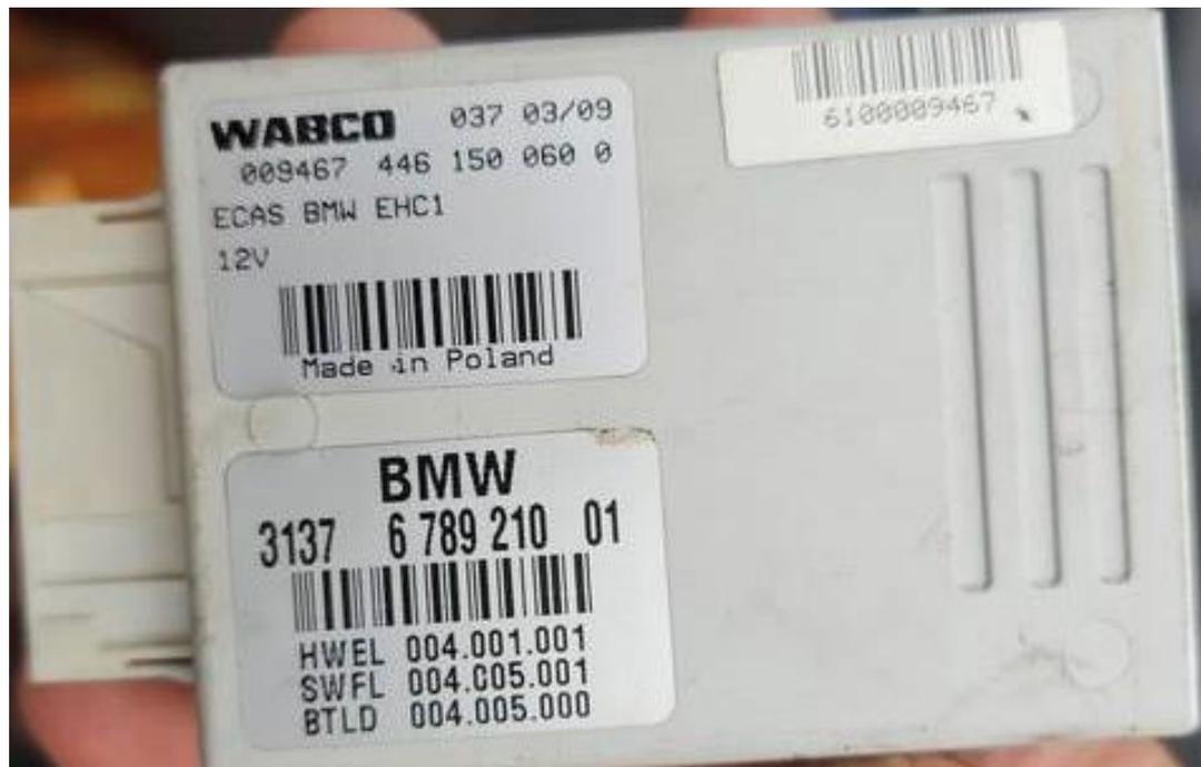
2. 安装好全新 EHC 电子行车高度模块后，需对模块进行设码，用 X-431 PADV 进入宝马诊断软件，点击【系统列表】；
