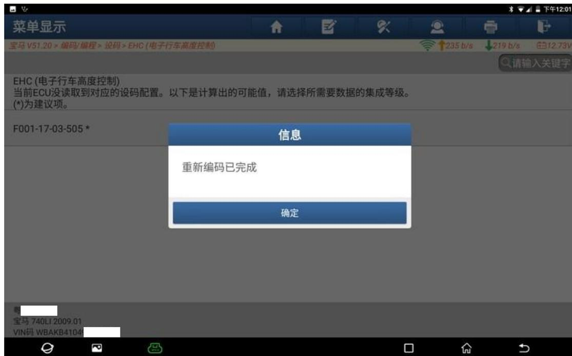
14. 返回读取故障码，故障码消失，设码成功。
