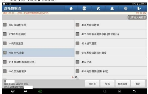
9. 发动机怠速下,空气流量数据为 25. 3kg/h,数据流远远超出标准值,标准值 为【12-16】;
