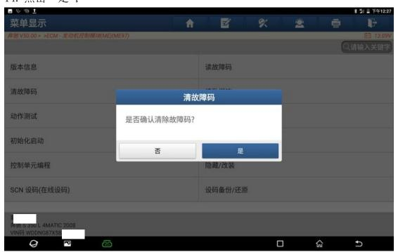
15. 关闭点火开关,点击"确定";
