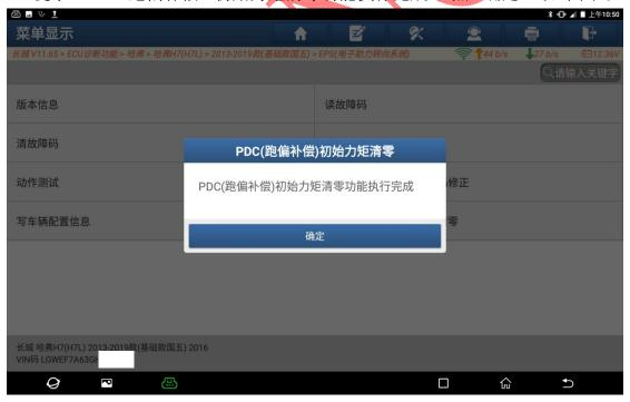
14. 执行一遍清码,重新读码,显示"无故障码",(如下图);
