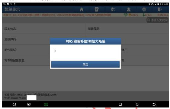
13. 提示"PDC(跑偏补偿)初始力矩清零功能执行完成",点"确定"(如下图);
