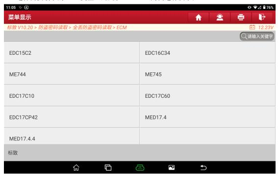
21. 选择类型后弹出下图提示框,如果已经读取保存了 MED17.4 的 EEPROM 数据,点击确定继续执行,如果未读取保存 EEPROM 数据,执行步骤 1 进入编程器读取保存相应类型的 EEPROM 数据:
