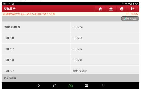
6. 输入发动机的 ECU 类型名,如图输入 MED17.4,点击"确定",自动识别类型;
