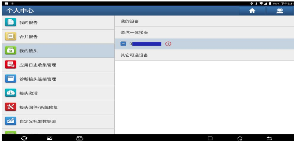
3.3 点击【**诊断接头连接管理**】，然后再点击“使用蓝牙通讯模式”，即可设置为蓝牙模式。
