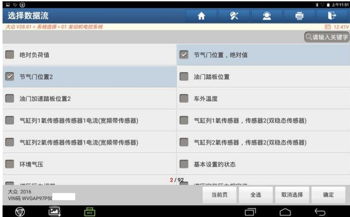
9. 启动发动机，在怠速状态下节气门位置绝对值和节气门位置 2 数据流值一直在 14-13 之间来回波动，节气门规定值数据流值为 5.5%。
