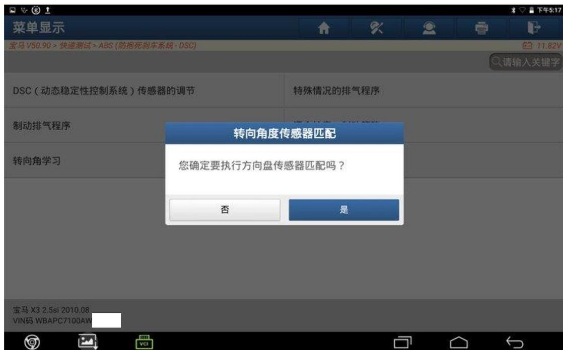
11. 将车辆停在水平地面，方向盘回正，点击“确定”；
