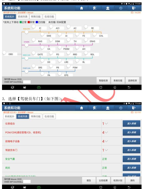
4. 读取到的故障码为"电动车窗电机,机械故障"(如下图);
