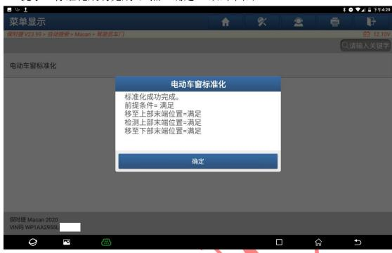
11. 清除故障码, 然后重新读取故障码, 显示"无故障码", 电动车窗校准完成(如下图)。
