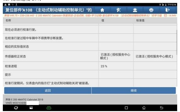
13. 校准进度 100%,将车辆开回维修点以后,点击"继续",校准完成;
