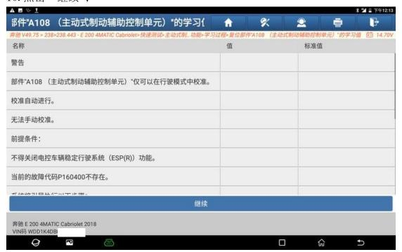
11. 将车辆以 30KM 以上时速行驶,车辆会自动进行校准,当前校准进度 0%;
