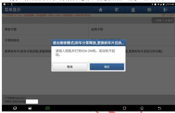
15. 提示"电子驻车处于释放状态",满足条件点"确定"(如下图);
