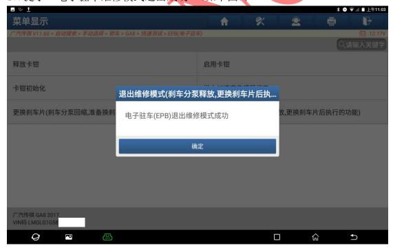
18. 查看仪表, 电子驻车维修灯消失, 验证电子手刹可以正常使用, 操作结束(如下图)。
