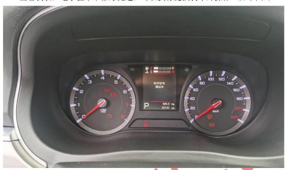
13. 更换完成后,选择"退出维修模式(刹车分泵释放,更换刹车片后执行的功能)"(如下图);
