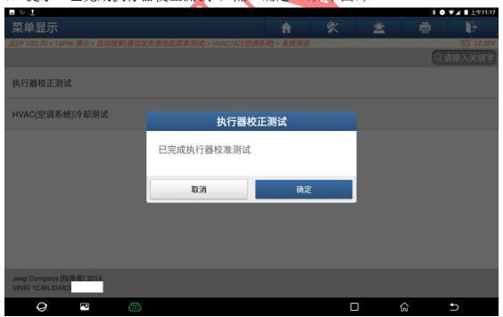
10. 数据显示, 执行器校正完成, 点返回按键退出, 校正结束(如下图)。
