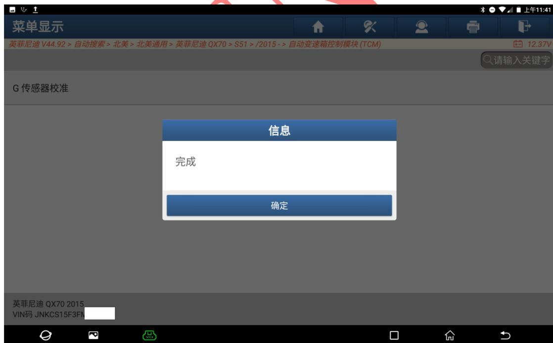
10. 清除一遍故障码，重新读码，显示“无故障码”，校准结束（如下图）。
