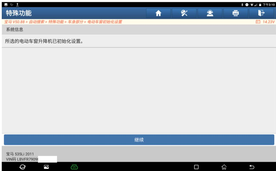
15. 执行清码后，重新读取故障码，显示“无故障码”，校准结束（如下图）。
