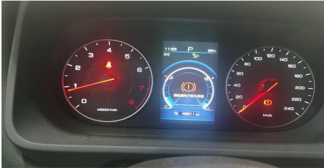
9. 维修完成后，选择【维修模式（刹车分泵释放，更换刹车片后执行的功能）】（如下图）；
