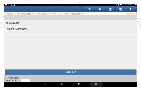
16. 再次进入"01 发动机电控系统"进行读码,故障码"P1A9100 气缸列 1 颗粒过滤器,激活指示灯"已被清除,仪表上的故障灯也已熄灭,操作结束。
