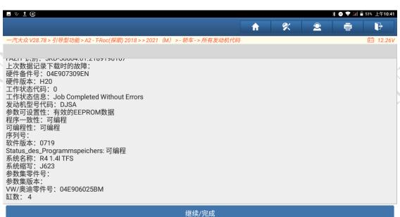
11. 此时启动汽车发动机, 使转速大于 650rpm, 并怠速运转, 大约 15 秒;
