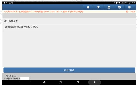
13. 接下来根据提示进行踩下/释放制动踏板的操作,直到提示信息中的状态由"未激活"变成"激活",此过程大约 45 秒,见下图;
