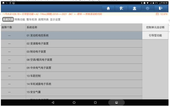
5. 根据车辆的实际配置选择系统型号,此处选择"0001-发动机电控系统1.2-1.4 FSI",如下图;
