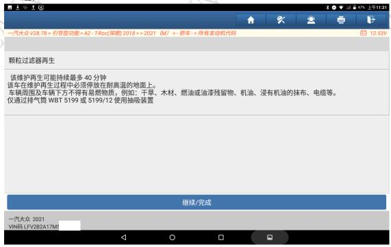
8. 首先关闭点火开关,关闭之后点击"继续/完成"按钮,然后再打开点火开关,见下图;
