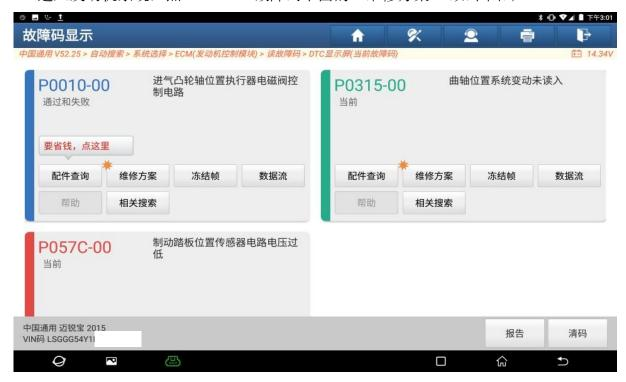
3. 认真阅读维修方案。电路/系统检验。1. 执行故障诊断仪上的"曲轴位置系统偏差读入"程序。(如下图):
