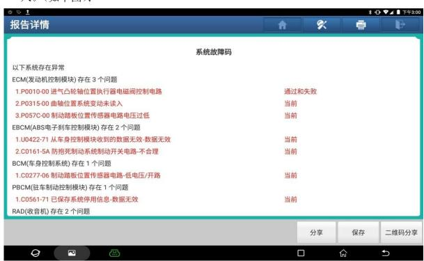
2. 进入发动机系统,点 P0315-00 故障码下面的"维修方案"(如下图);
