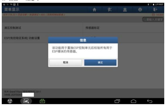
9. 打开点火开关,方向盘居中,拉起驻车制动,点击"确定";
