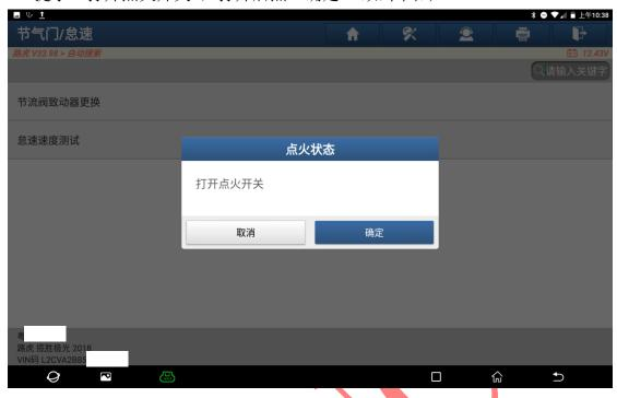
9. 提示"关闭并打开点火开关",满足条件后,点"确定"(如下图);
