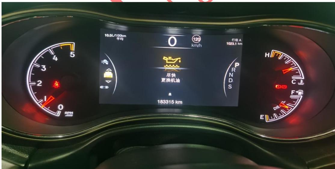
2. 更换机油后，使用“X-431 PADV”设备，选择【吉普】车型，连接进入后选【自动搜索】（如下图）；
