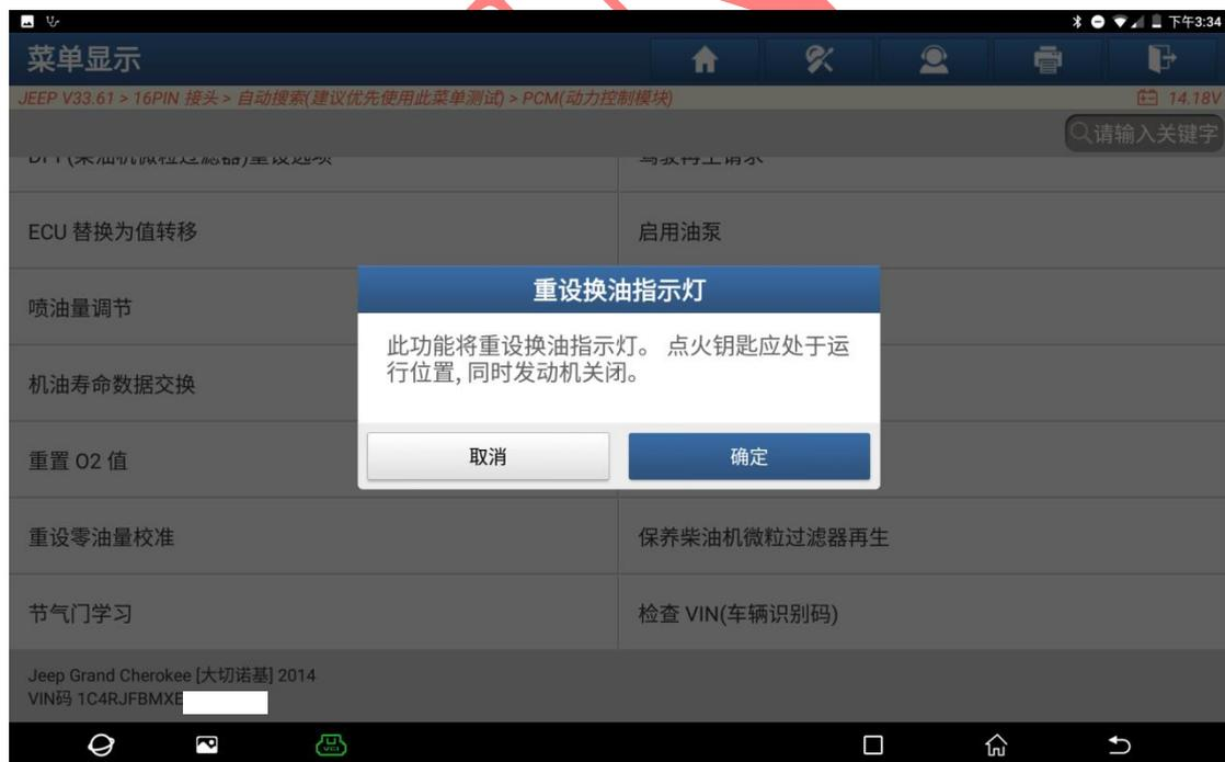
10. 成功执行后提示“已重设换油指示灯”，点“确定”（如下图）；
