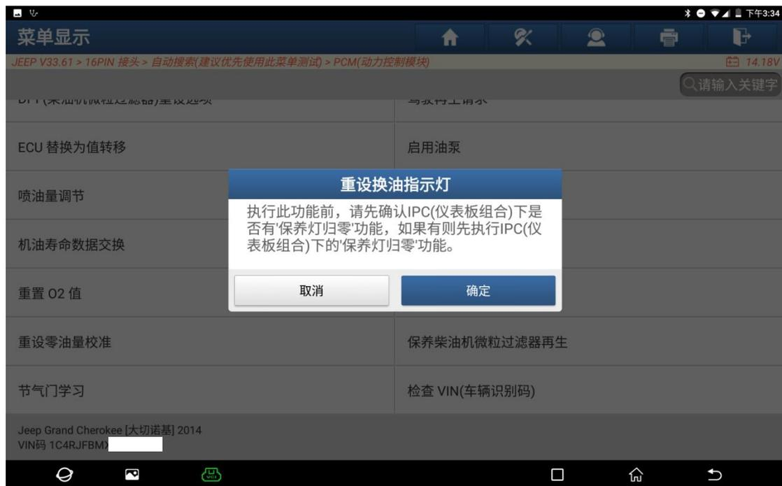
9. 提示“打开点火开关，发动机关闭”，点“确定”进入下一步（如下图）；
