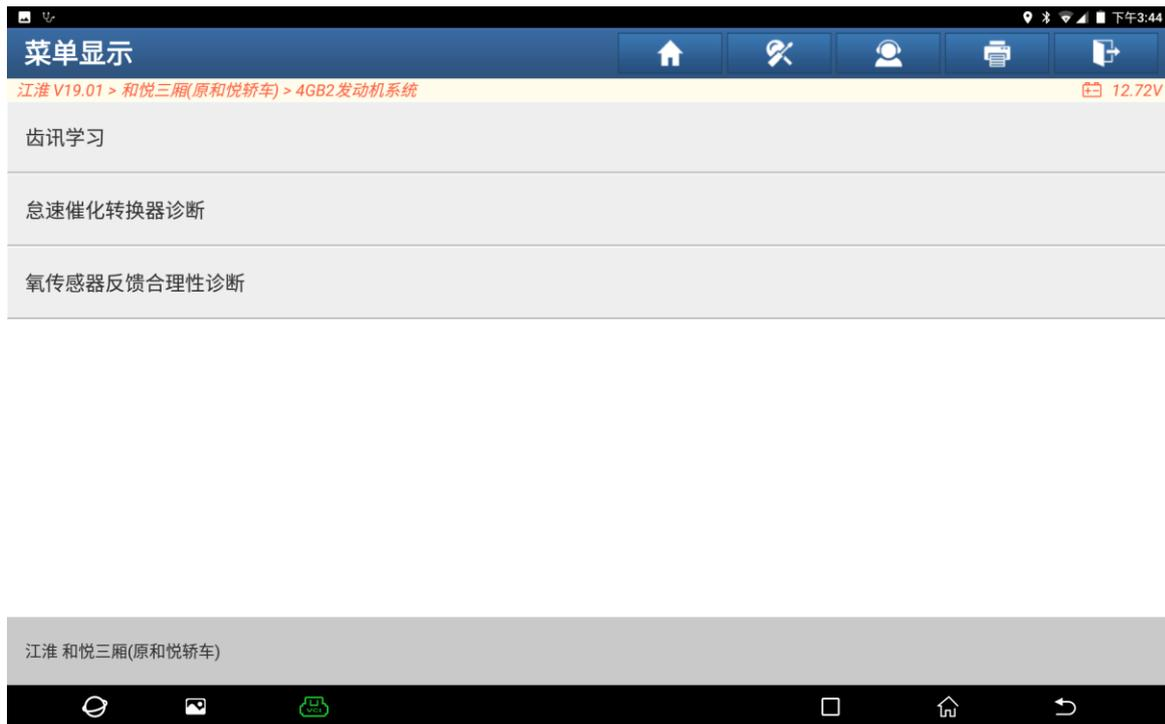
5. 满足以下条件: 怠速使水温高于 60 度, 启动发动机车辆运行超 10 秒, 关闭车辆负载。点击 “是”(如下图);
