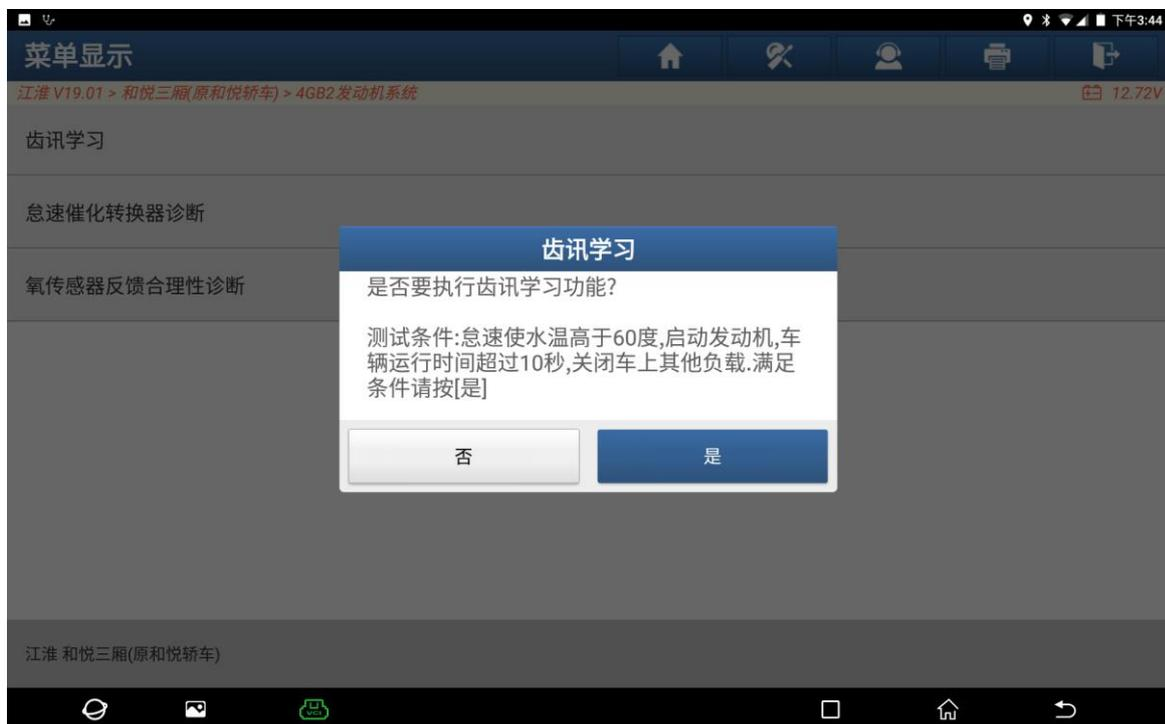
6. 将油门迅速踩到底并保持不松开，如果发动机转速能超过 5000rpm，赶紧松开油门并找问题，解决后再进行学习。正常情况是：发动机转速在 1300-4500rpm，反复 2-5 循环，最后会在 4500rpm 附近振动，此时可以松开油门，10 秒钟不完成也要开油门，之后点击下面“确定”按钮（如下图）：
