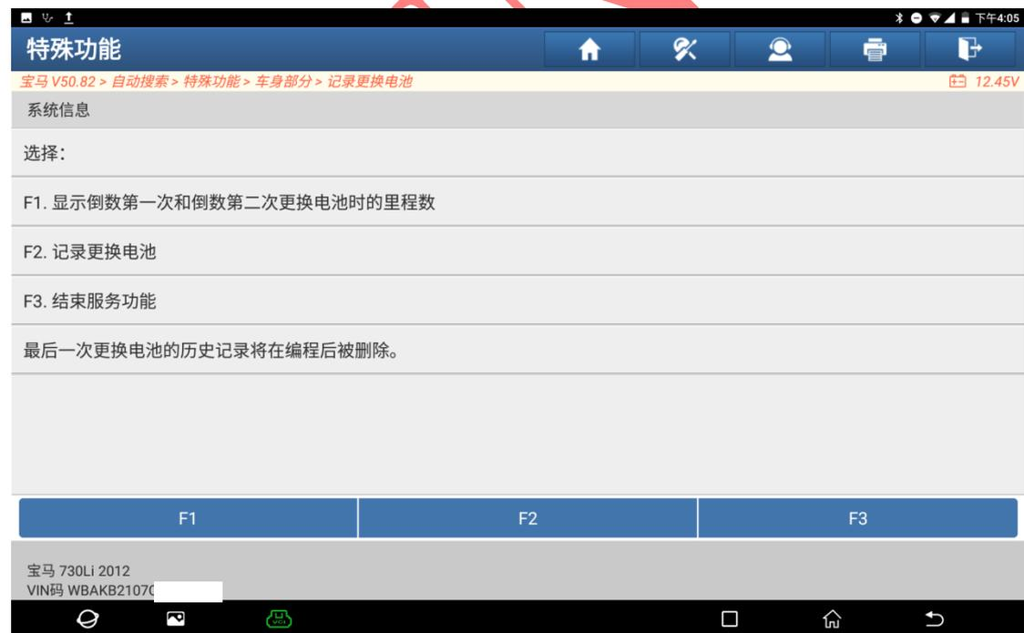
8. 根据更换电池的容量，选择【F1 记录电池更换：相同容量】，点“F1”（如下图）；
