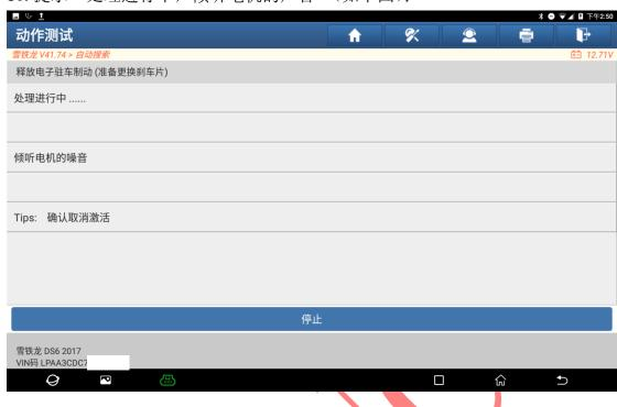
11. 提示"激活结束,检查仪表板电子驻车灯是否熄灭",检查无误后,点"确认" 更换刹车片(如下图);
