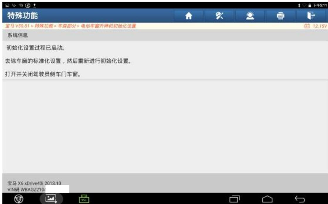
8. 初始化完成，测试车窗能否一键打开/关闭，如能正常一键打开/关闭，点击“继续”；
