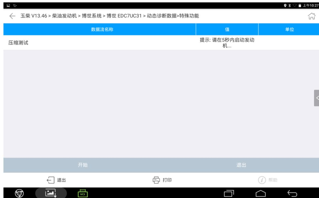
8. 出现请等待界面时停止启动发动机，使钥匙保持在打开点火开关的状态等待完成之后即可以显示各个汽缸在压缩冲程时对应的曲轴转速。点击“确定”完成压缩测试的操作。
