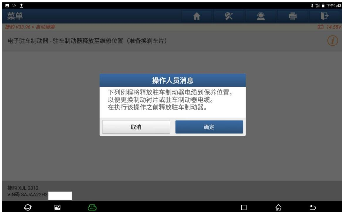
6. 在工作完成后，驻车制动器将需要重新标定（如下图）；
