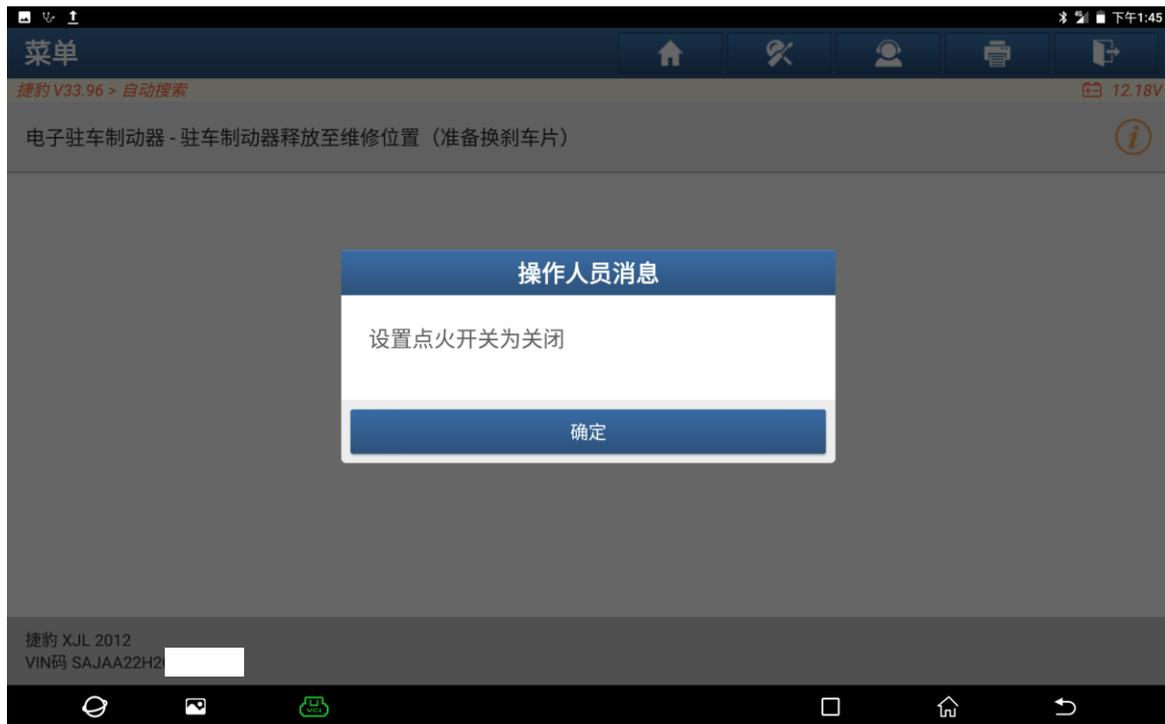
15. 释放后仪表提示：驻车制动器需要校准踩脚制动器并拉合驻车制动器。更换好刹车片后执行提示操作即可。
