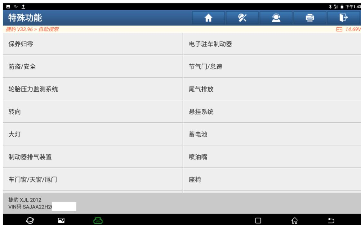
3. 更换前选择【电子驻车制动器-驻车制动器释放致维修位置 (准备换刹车片)】;
