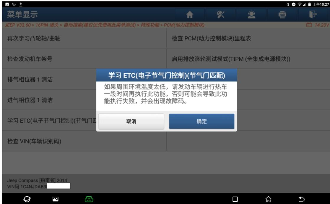
9. 提示“将油门踏板踩到底，保持节气门全开”，踩下后点“确定”（如下图）；
