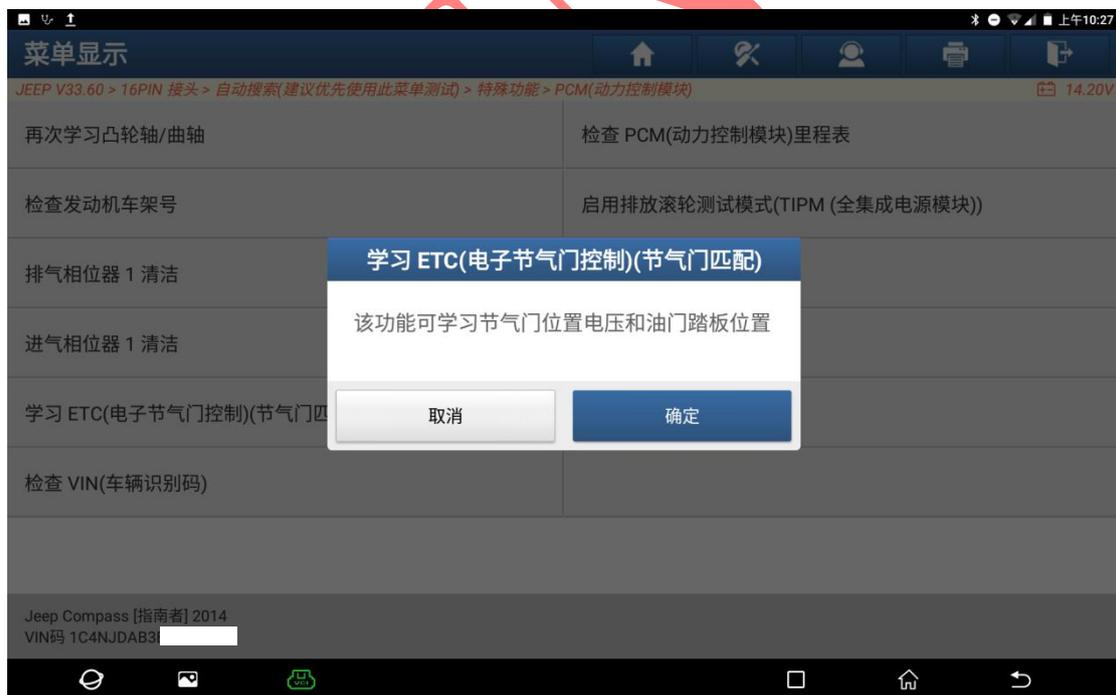
8. 提示“将车辆热车一段时间，在执行此功能，否则会导致执行失败”，热车后点“确定”（如下图）；
