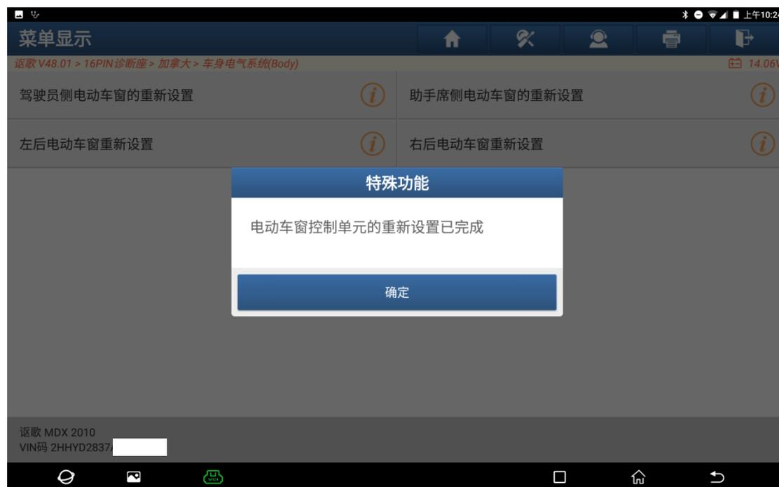
13. 清除一遍故障码，关于乘客侧车窗的故障已经消失，学习结束（如下图）。
