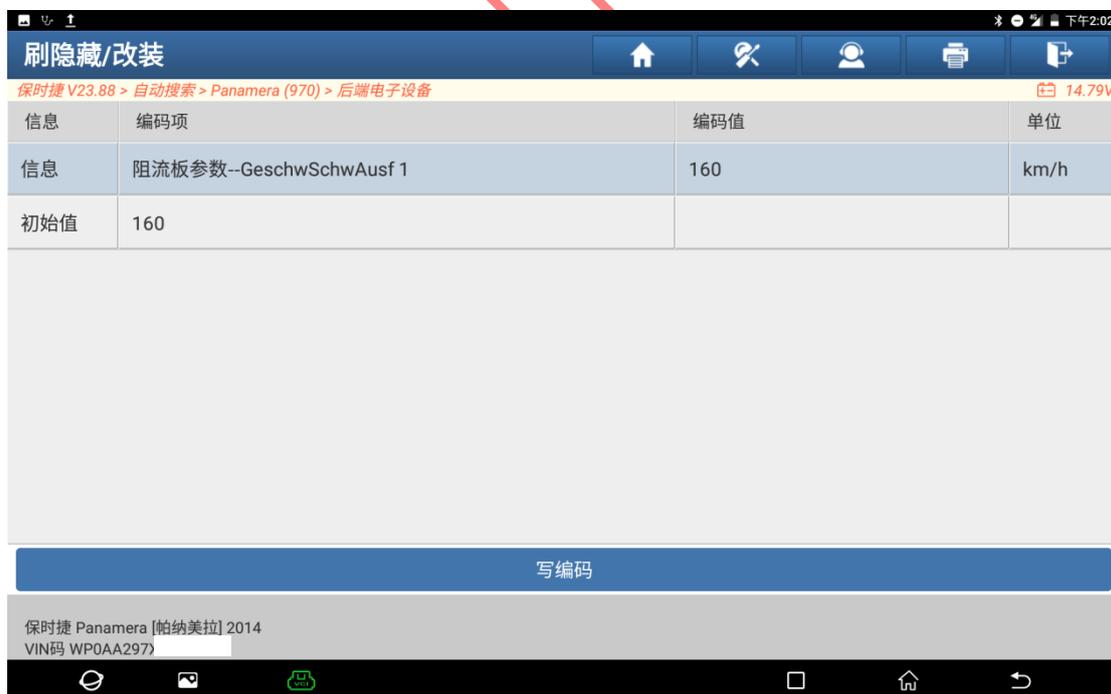
12. 出去路试，速度达到“90km/h”以上，仪表不在提示阻流板故障，设定完成，因最高速度只能设定为“160km/h”，阻流板故障未维修，因此车速达到“160km/h”以上时，仪表任然会报阻流板故障（如下图）。
