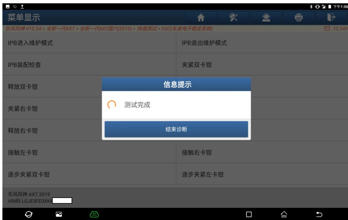
6. 刹车片更换后选择【IPB 退出维护模式】(如下图);
