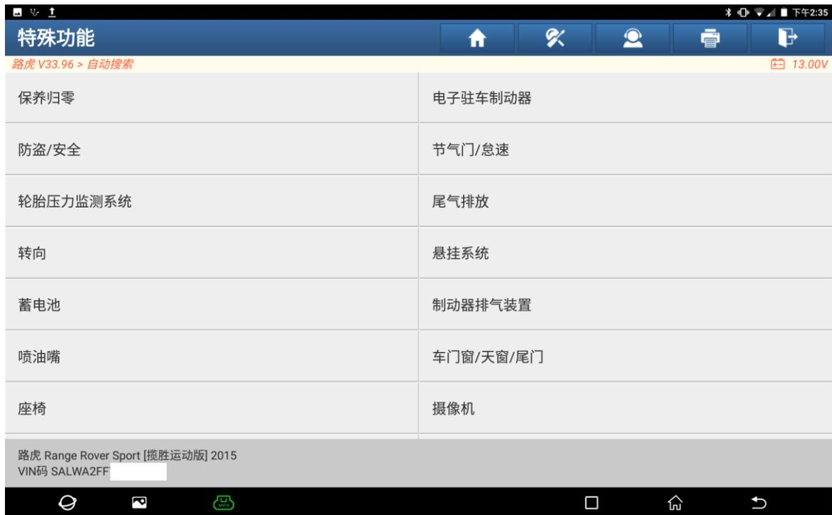
3. 更换前选择【驻车制动器-驻车制动块更换-释放维修位置 (准备换刹车片)】(如下图);
