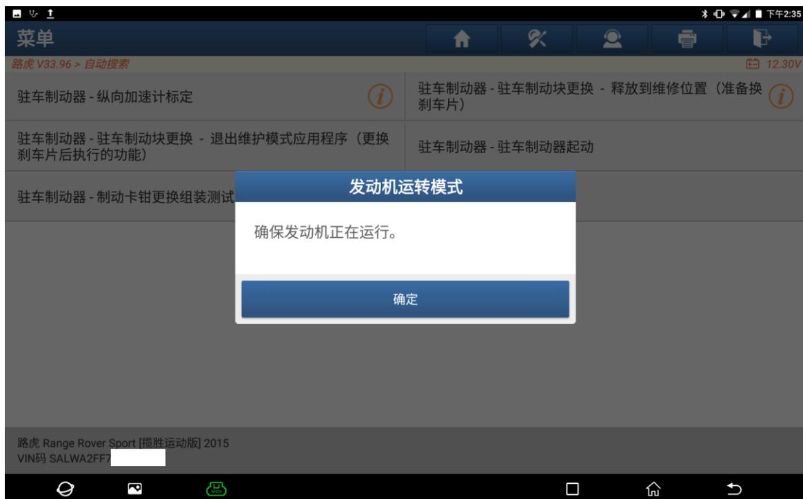
6. 确保车辆在水平地面上处于静止状态，刹车踏板未踏下，释放驻车制动器。
