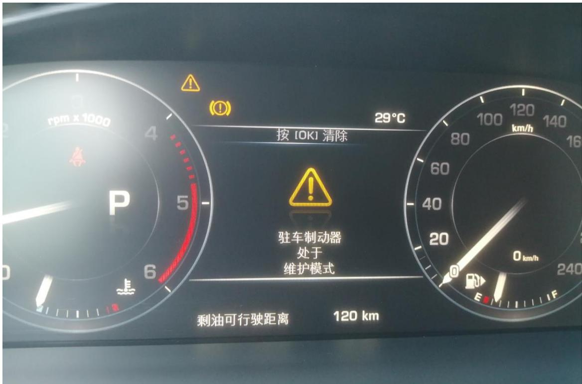
15. 更换后选择【驻车制动器-驻车制动块更换-退出维护模式应用程序（更换刹车片后执行的功能）】（如下图）；
