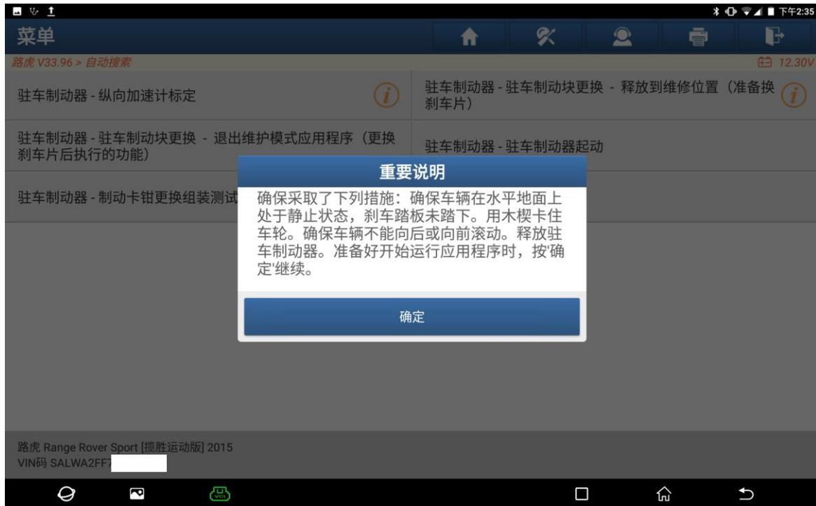
7. 此应用程序将回缩刹车分泵，以便安装新制动片。“确定”（如下图）；
