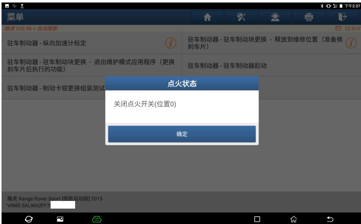
14. 仪表提示：驻车制动器处于维修模式（如下图）；
