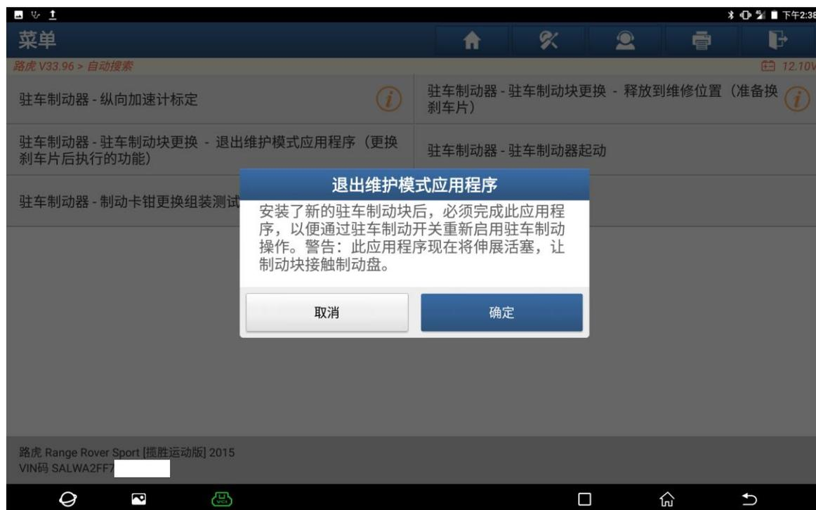
23. 退出维护模式应用程序完成。“确定”（如下图）；
