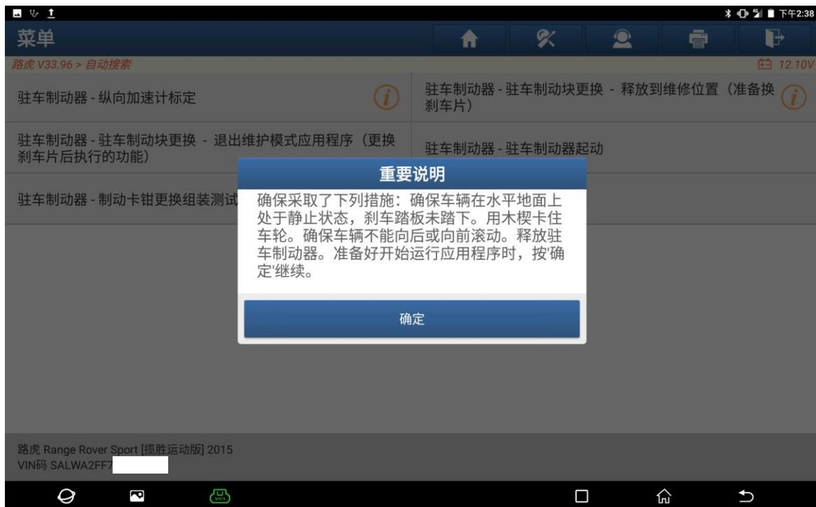
22. 安装了新的驻车制动块后，必须完成此应用程序，以便通过制动开关重新启用驻车制动操作，点击“确定”（如下图）；
