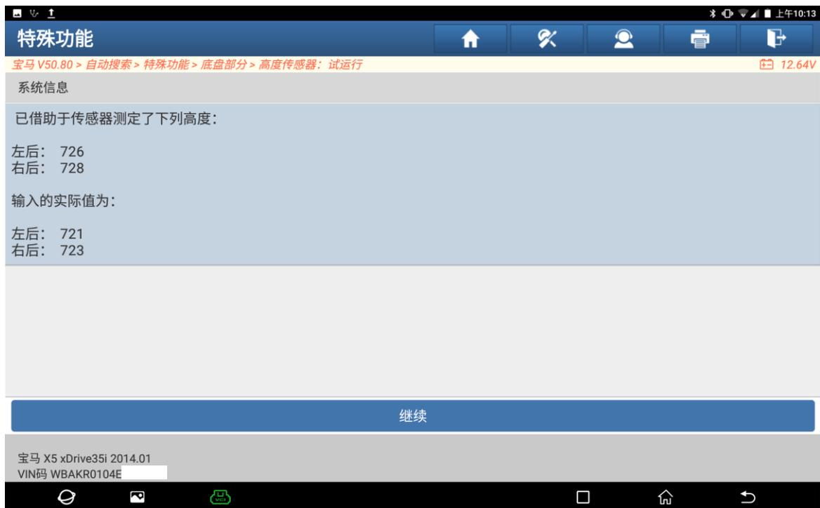
12. 后桥匹配值已成功写入 ICM 控制单元。继续前桥匹配。“继续”（如下图）；
