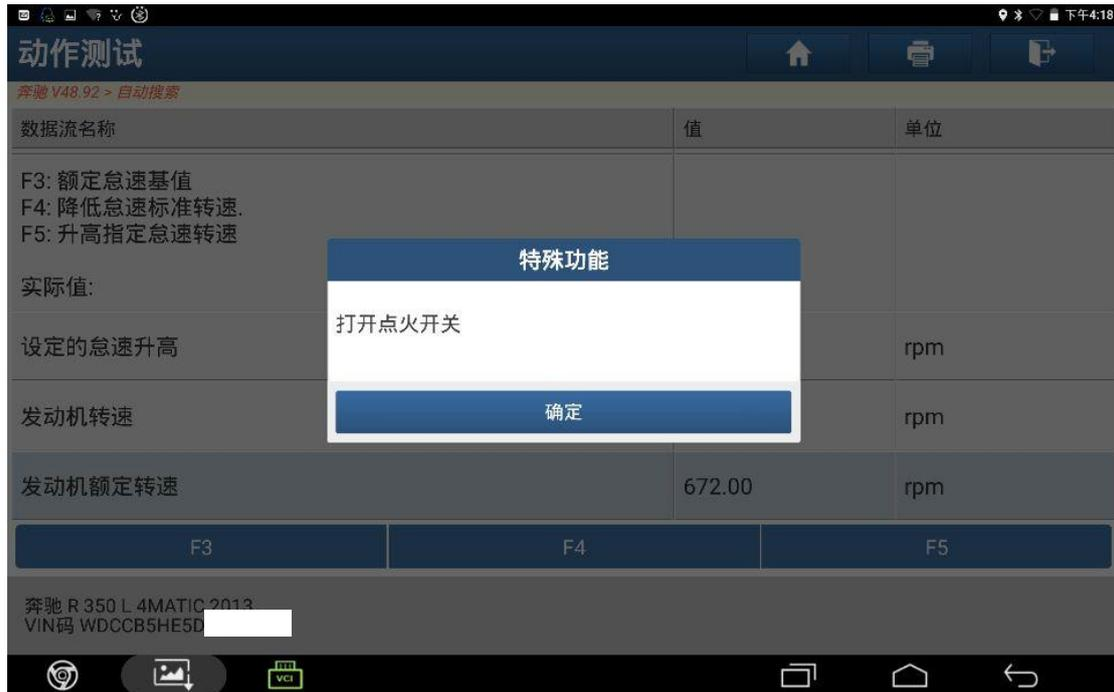
挂 D 档，发动机转速接近 700 转，怠速升高调整成功。
