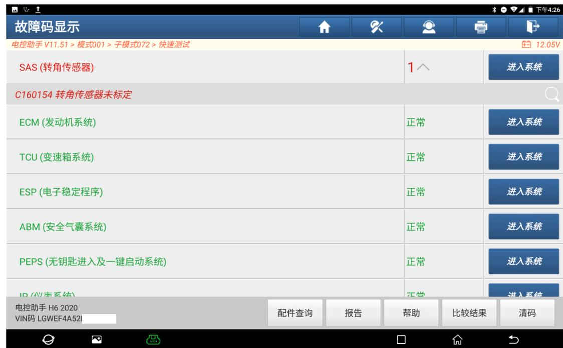
5. 读取故障码, 显示“转角传感器未标定”(如下图):
