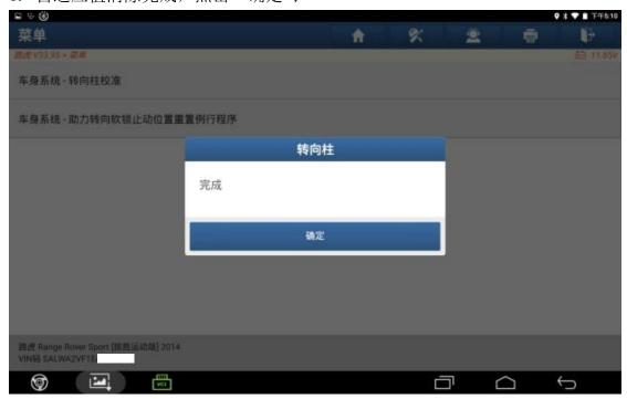
7. 转向柱校准,点击"确定";
