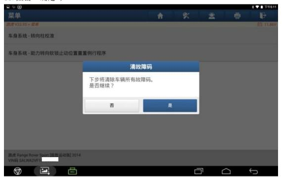
12. 关闭点火开关,点击"确定";
