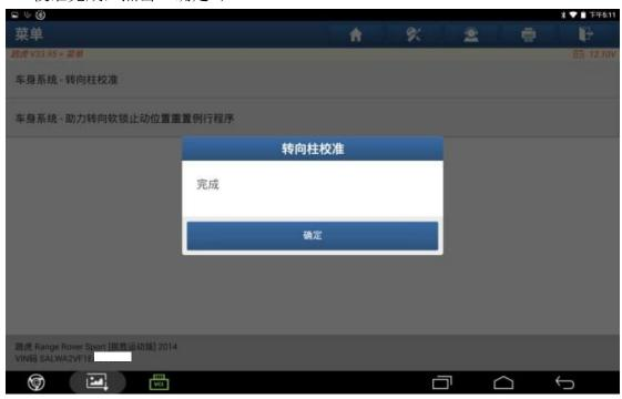
9. 关闭点火开关,点击"确定";
