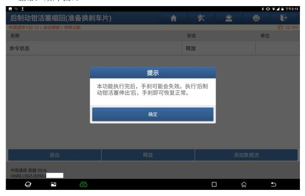
8. 此时更换刹车片,更换好后执行【后制动钳活塞伸出(更换刹车片后执行的功能)】。(如下图)。
