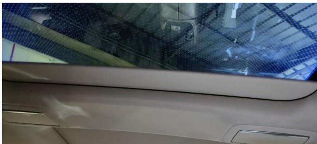
2. 进入 FZD 天窗功能中心，读取故障码，系统无故障码。需对天窗遮阳帘进行校准
