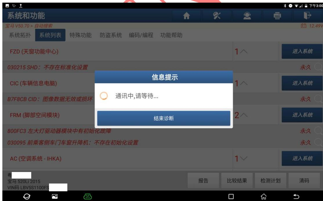
4. 读取到故障码“前左大灯驱动器模块中有初始化故障”（如下图）；
