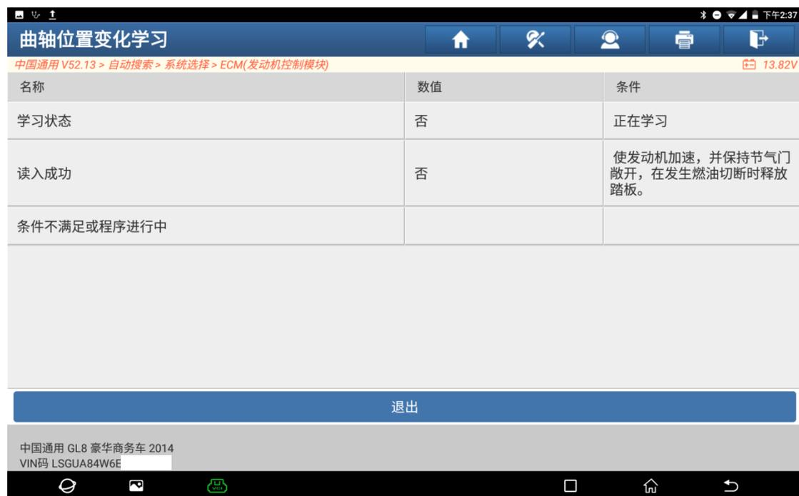
11. 燃油自动切断后，松开踏板，提示“成功通过测试”，点“确定”结束学习（如下图）。
