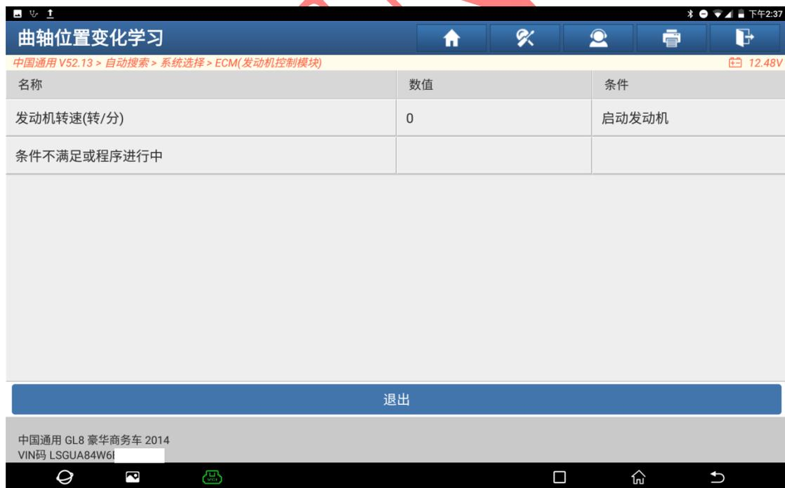
10. 提示“踩发动机油门，直到燃油自动切断后松开油门踏板”（如下图）；
