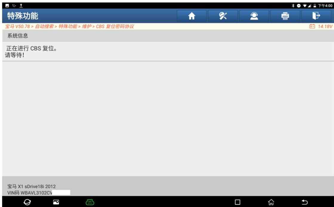
9. 执行复位后，制动液显示“100%”，点“F11”（如下图）；
