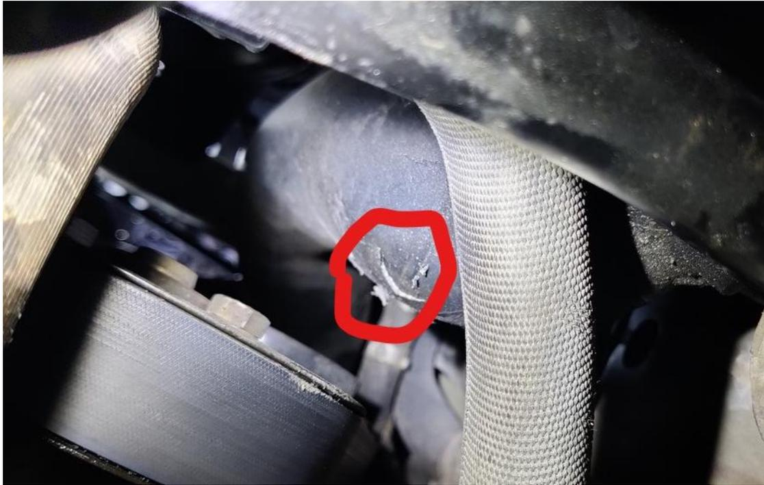
5. 更换全新涡轮中冷连接管，试车正常，车辆故障码消失故障排除
