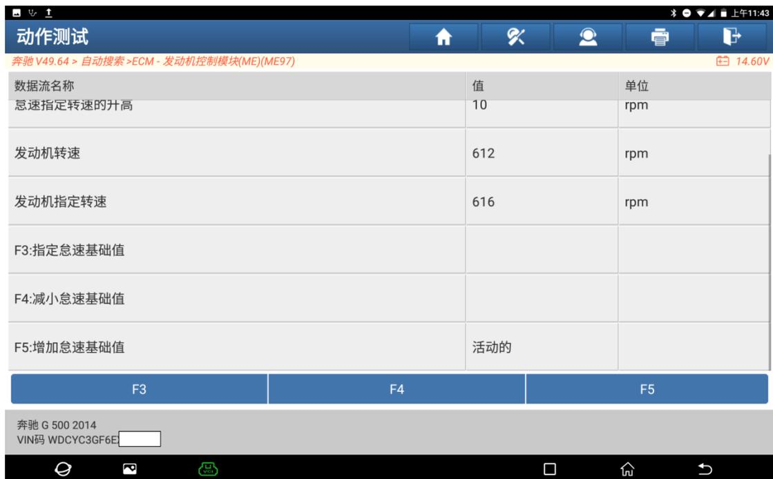
9. 选择完成后，点右下角的返回菜单，提示“关闭点火开关”，然后点“确定”（如下图）；
