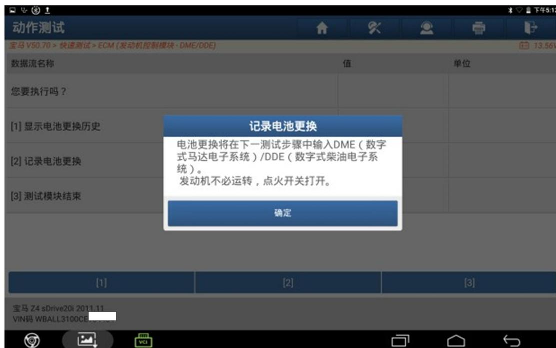
6. 该车原车装配了普通的铅酸蓄电池，电池容量 71Ah，现更换的电池为 AGM 电池，电池容量 80Ah，所以需选择【[3]输入电池更换.....】。
